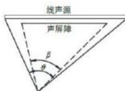
图 4.4-5 受声点与线声源两端连接线的夹角（遮蔽角）
